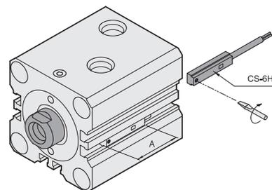
感應配置時不可距離磁感材料(碳鋼, 鑄鐵)過近(需大於10mm以上), 太靠近容易造成失效。
